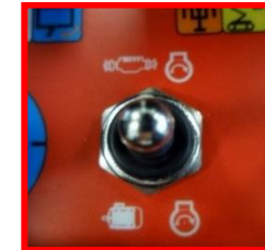
Figure 5 : levier de démarrage moteur à combustion interne/électrique (*en option) sur radiocommande/télécommande filaire.
