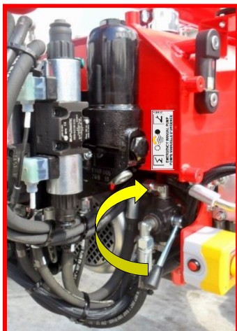
Figure 25 : robinet de la pompe manuelle en position récupération des stabilisateurs.
